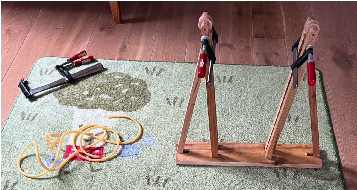
Abbildung 2: Erster Aufbau des Katapults
